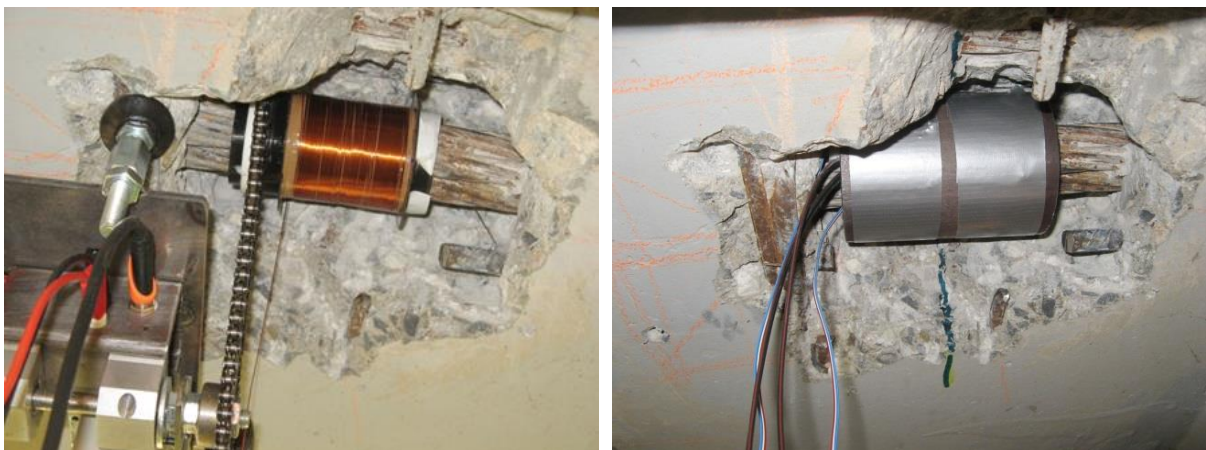
Obrázek 6.: Pohled na částečně navinutou primární cívku snímače a navíjecí zařízení (vlevo) a na dokončený snímač opatřený stíněním (vpravo).
