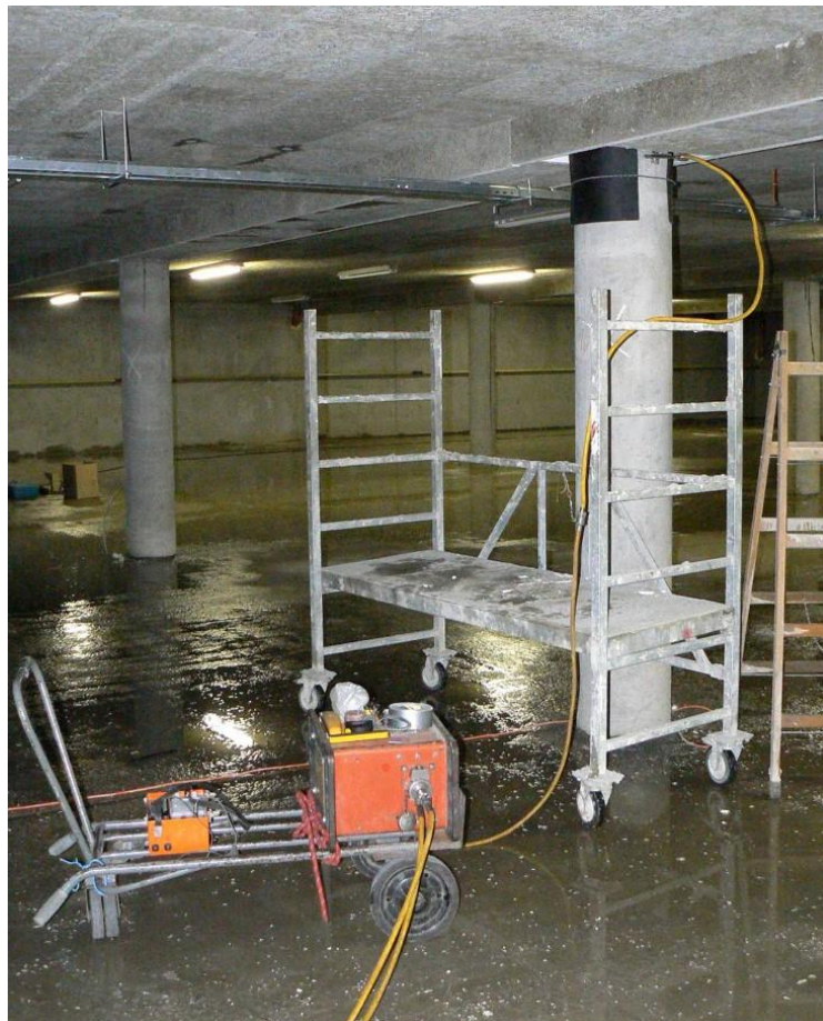
Obrázek 3.: Provádění radiografie vrcholové partie sloupů v 1. PP. Dobře patrný kryt se zářičem Co60, žlutá výsuvná hadice pro zářič a radiografický film na bočním líci sloupů.
