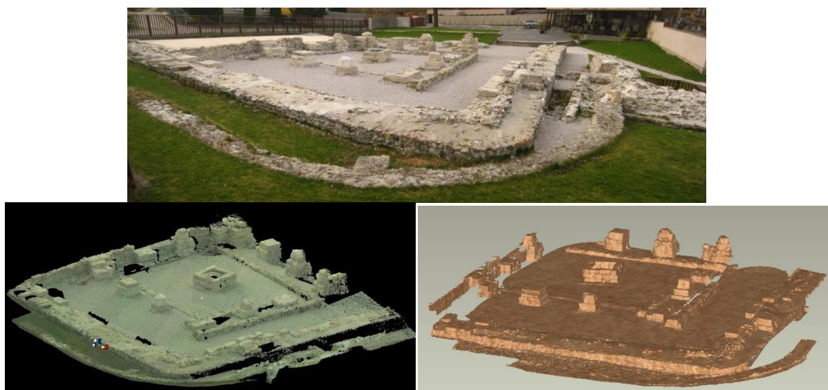
Obr. 6: Hradby (hore), mračno bodov (dole vľavo) a 3D model (dole vpravo)
