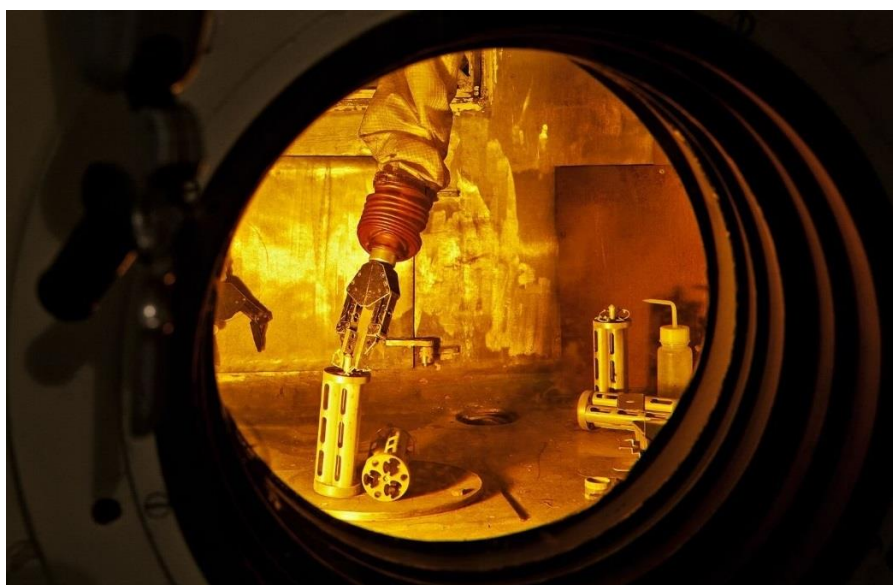
Obrázek 3.: Práce robotických manipulátorů v horké komoře v areálu ÚJV Řež a.s. [11]
