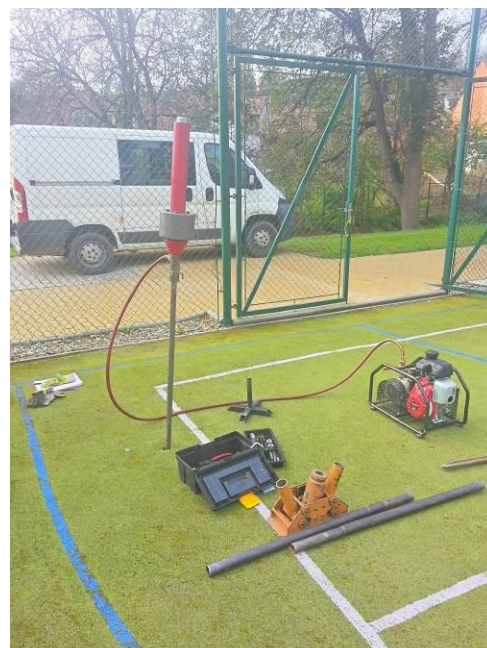
Obrázek 3: Pohled na penetrační soupravu DPM WILL GEOTECHNIK vrt J2
