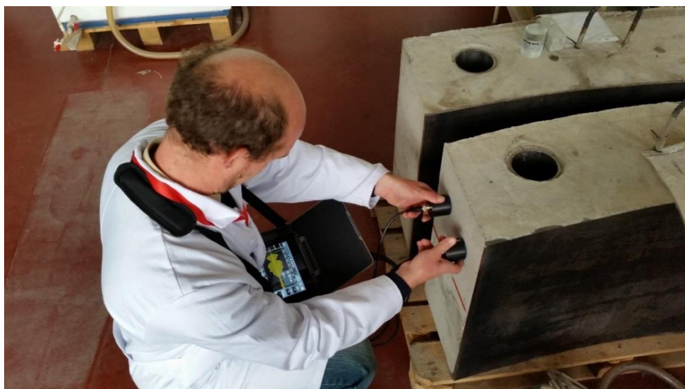
Obrázek 2.: Měření hloubky trhliny v 1:1 modelu betonu biologického stínění šachty reaktoru VVER 1000 Jaderné elektrárny Temelín pomocí nepřímé ultrazvukové metody.
