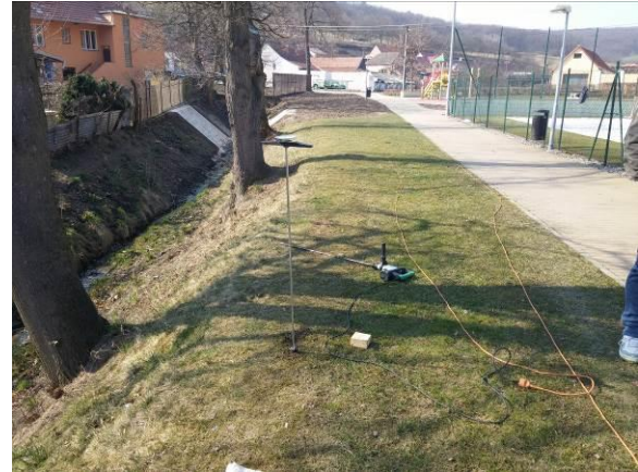
Obrázek 6: Měření teploty zeminy na levém břehu potoka Salajka, vpravo oplocení hřiště
